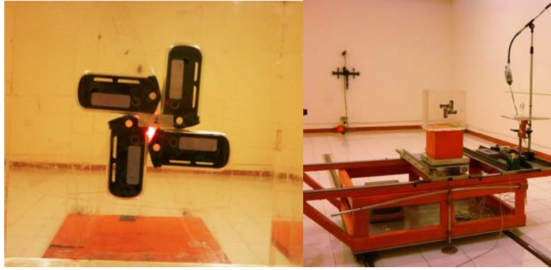
Gambar 3. Rangkaian formasi dosimeter OSL yang dipasang pada fantom dan siap mendapat penyinaran radiasi
